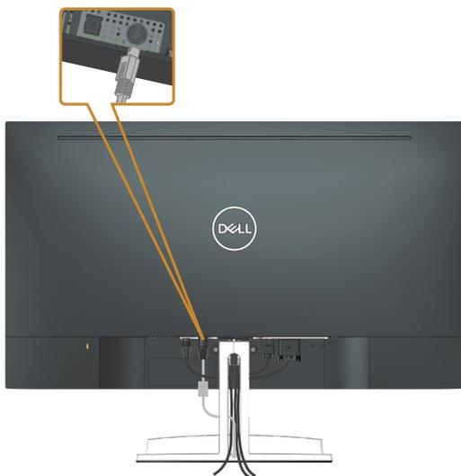
4. Inserte el soporte del cable conectado al cable del altavoz en la ranura del soporte. Ajuste la posición del soporte del cable a lo largo de la ranura como corresponde.
